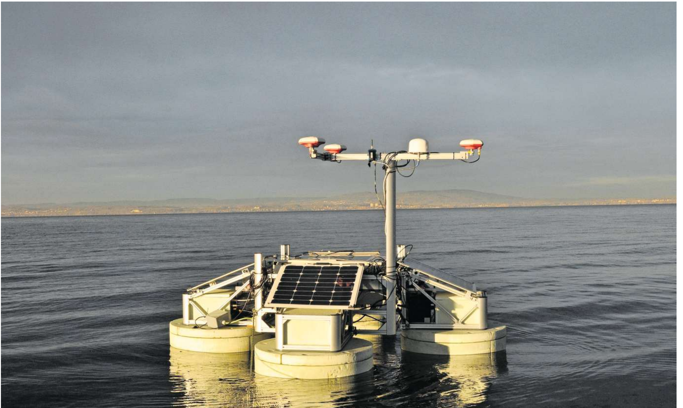
Der «Hydrocrawler» von Forschern des Fraunhofer-Instituts für Biomedizinische Technik hat Anfang November den Bodenseegrund um einen der Hügel hochauflösend vermessen. Bild: PD/ Amt für Archäologie Kanton Thurgau
